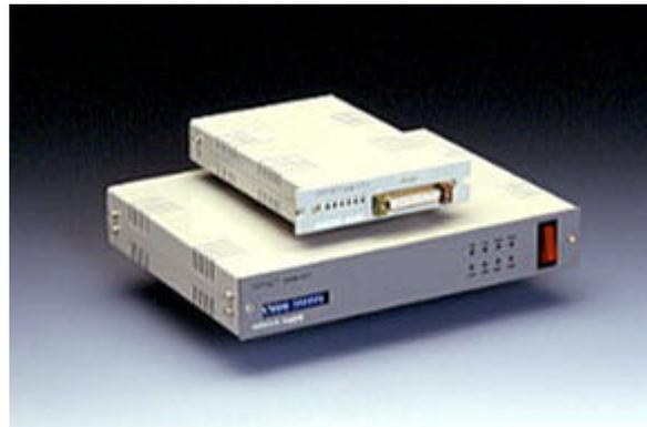
RS-232C から GP-IB 機器を制御するモード(モードA)と、GP-IB 側から RS-232C 端末等と通信するモード(モードB)およびトークオンリー/リスンオンリー(ONLY モード)が切替えて使用できます。
